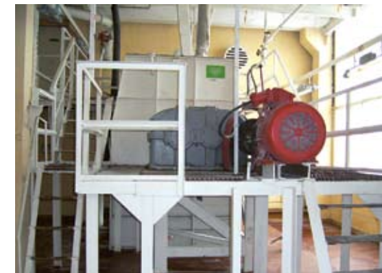
Смеситель для производства сыпучих моющих продуктов
