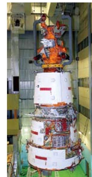
Установка научной аппаратуры на борту КА «Фотон-М» №4
