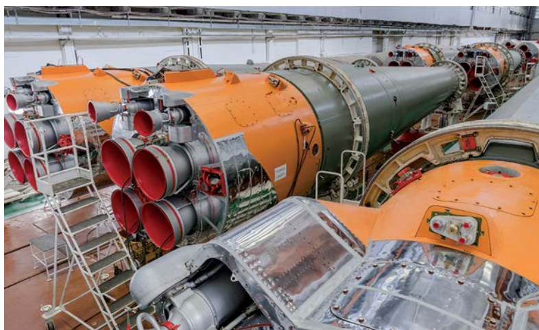
Блоки ракет-носителей в цехе окончательной сборки и испытаний
